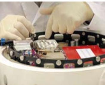
similares a las del experimento anterior en el interior del dispositivo Biopan, a bordo de la cápsula rusa Foton-M3.
